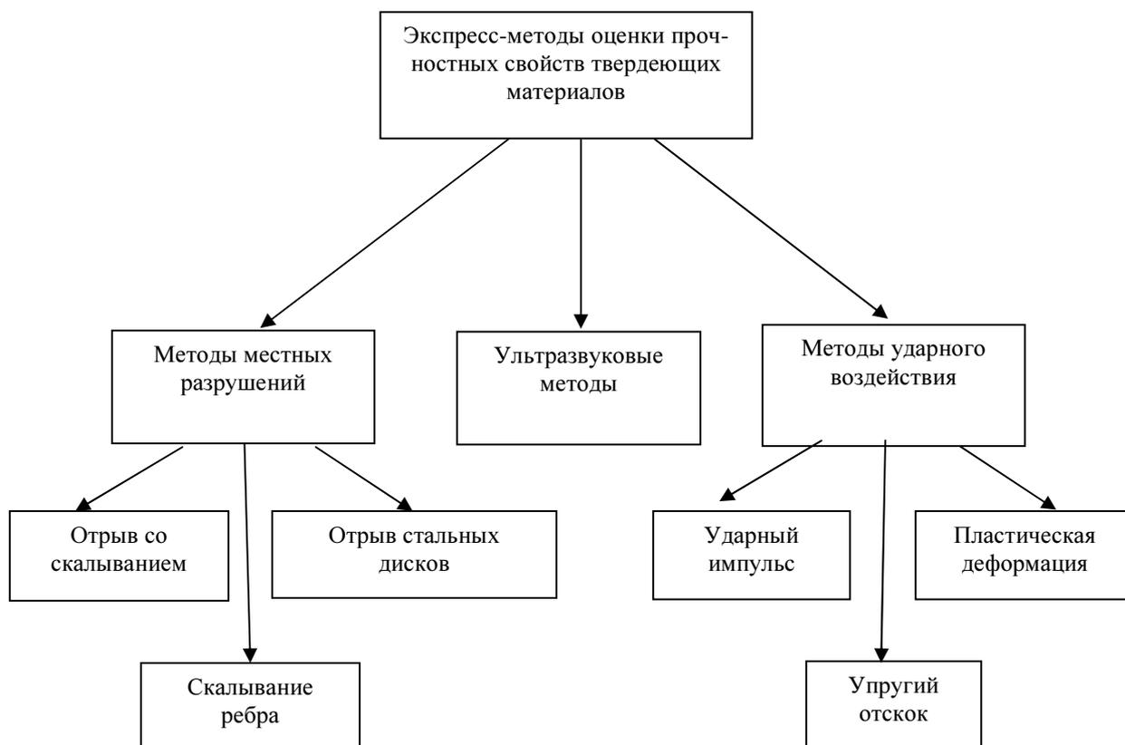
Рис. 1 – Классификация методов неразрушающего контроля твердеющих материалов
